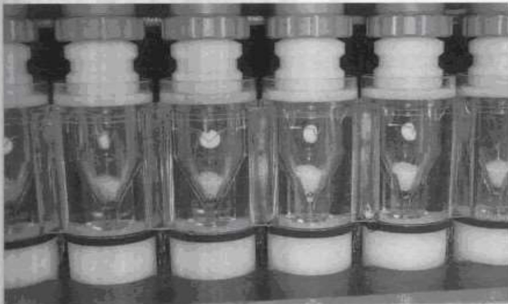
(d) Flow-through cell (USP IV).
